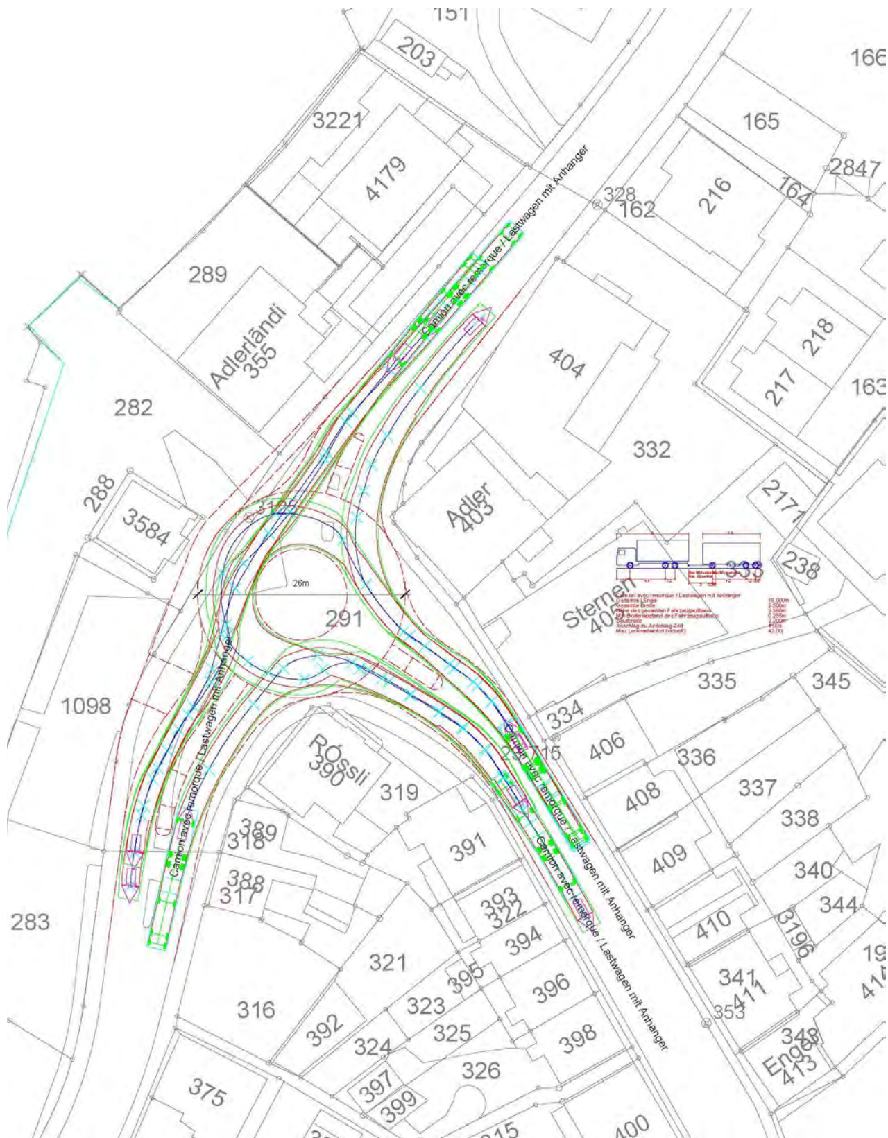
Kreisel Arth mit Schleppkurven (LKW mit Anhänger, SN 640 198a), Kreiseldurchmesser: 26m, grün: Hüllkurve Karosserie, massstabslos
